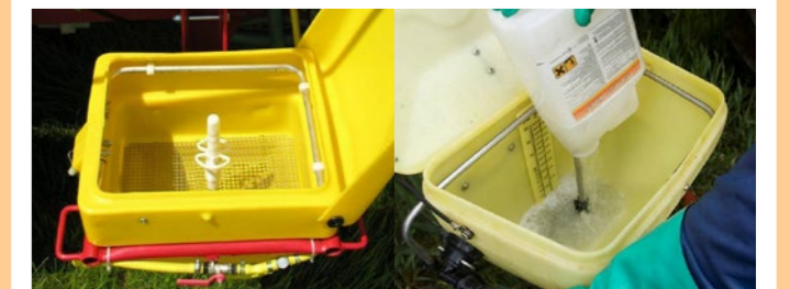
Einspülschleuse & Reinigung eines Behälters
