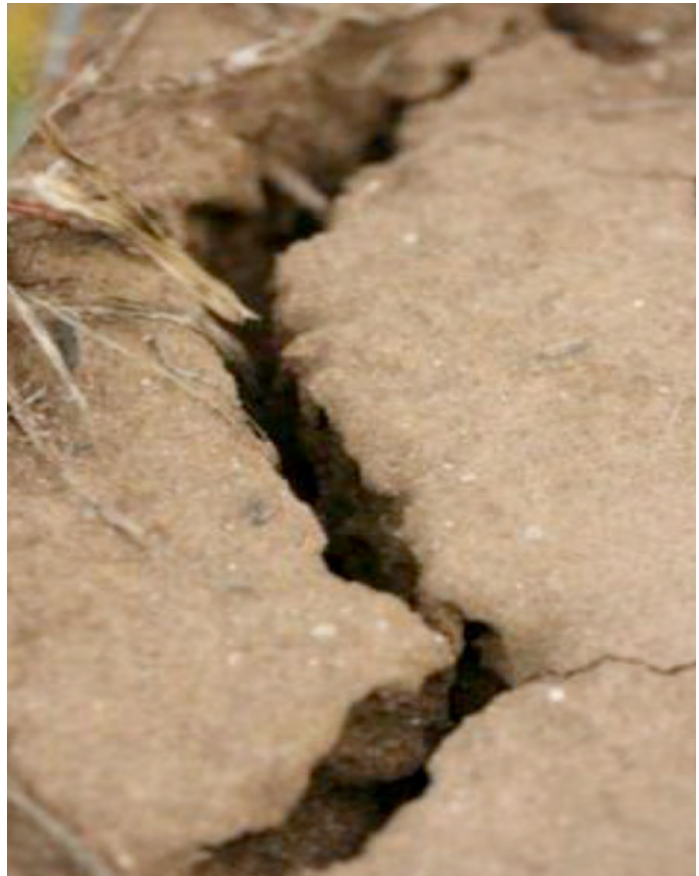
Tonboden mit Schrumpfrissbildung
